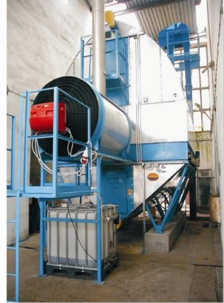
Przeptywy powietrza wymusza wentylator ssący, co umożliwia ustawienie suszarni w budynku i łatwe odprowadzenie zużytego powietrza.
